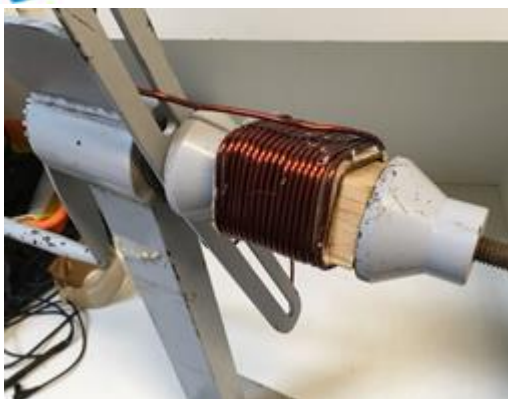
Figura 2 - Enrolamento primário do transformador e chapa de ferro Silício E-I utilizada.
