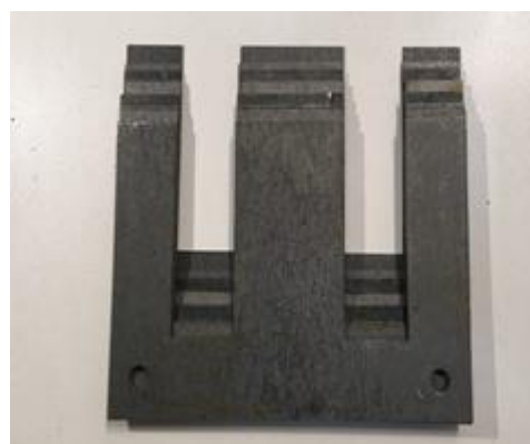
Figura 2 - Enrolamento primário do transformador e chapa de ferro Silício E-I utilizada.
